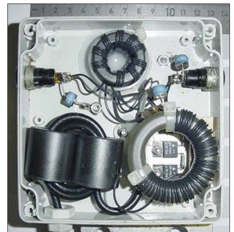
Bild 5: Das Innere des Einspeisenetzwerks
