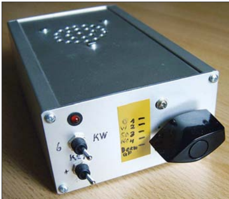
Bild 1: Frontansicht der Umschaltbox; vorn rechts der Antennenwahlschalter, links von oben nach unten LED-Betriebsanzeige, Schalter 6 m/KW, 12-V-Fernumschaltung
