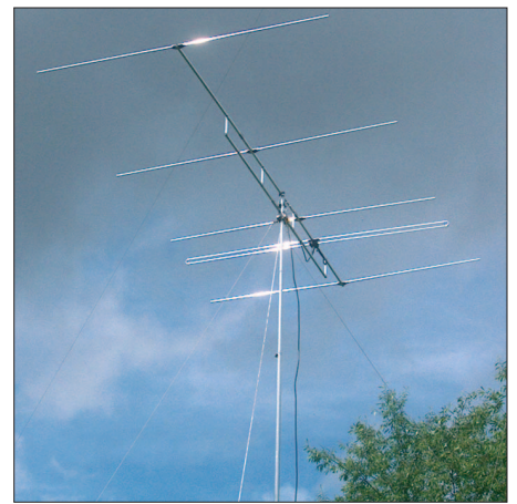
Antenne F6/5 an einem 10-m-Steckmast; zu anderen Antennen wäre genügend Abstand einzuhalten! Foto: DL2RD
