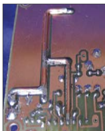
Bild 5: Die im Layout an den breiteren Leiterbahnen erkennbaren Leiterzüge sind mit aufgelöteten Kupferdrähten von 1,5 mm 2 zu verstärken.
