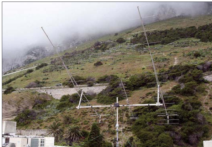
Antennenstandort in Gibraltar auf dem Hoteldach: Die zwei 17-Element-Yagis ergeben knapp 16 dBd, die 19-Element-Yagi für 70 cm etwa 14 dB Gewinn. Fotos: DF2ZC
